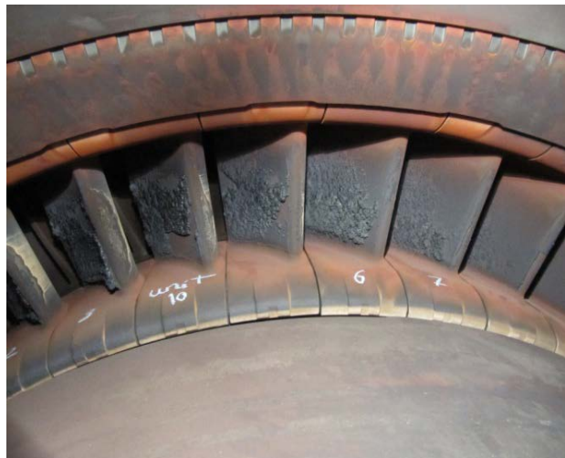
شکل ۱۰: اثر پودر سیاه روی پره های ثابت واحد ۲
