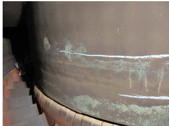
شکل ۱۲: تاثیر آلودگی سوخت گاز بر Inner Casing
