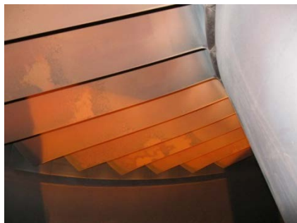
شکل ۲: تشکیل رسوب و خوردگی داغ برپره های توربین گاز واحد ۲ نیروگاه خرمشهر
