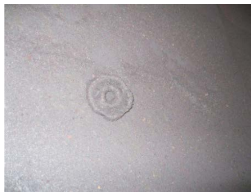
شکل ۷: نمونه پودر سیاه رنگ و رسوب تشکیل شده در توربین واحد ۲ نیروگاه خرمشهر
