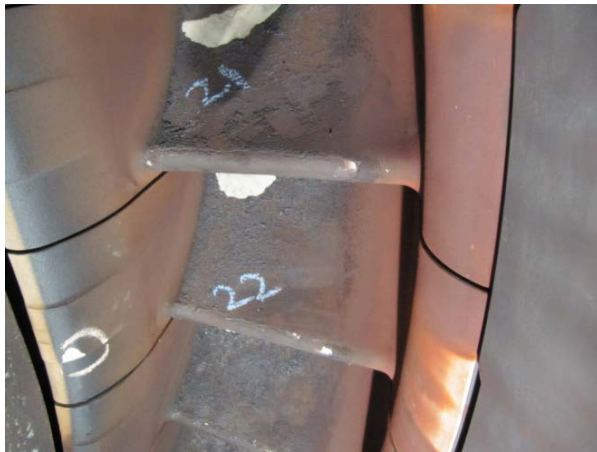
شکل ۱۱: پره های ثابت پس از تمیزکاری
