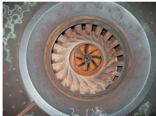
شکل ۵: اثر خوردگی بر روی برنرهای واحد ۲ نیروگاه خرمشهر
