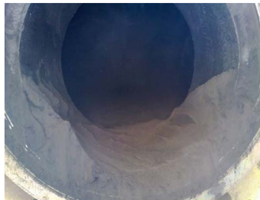
شکل ۸: پر شدن مخزن فیلتر سایکلونی
