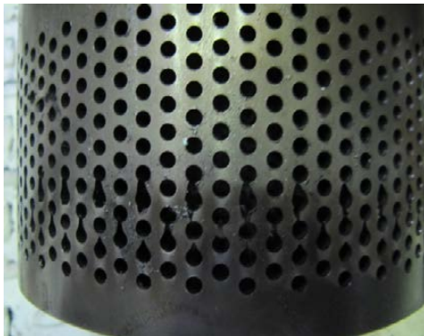
شکل ۹: آسیب Cage کنترل ولو اصلی گاز
